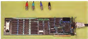
La Leonard 1 Plus è completa del cavo di interfacciamento video che termina con il connettore SMC di collegamento al monitor.
